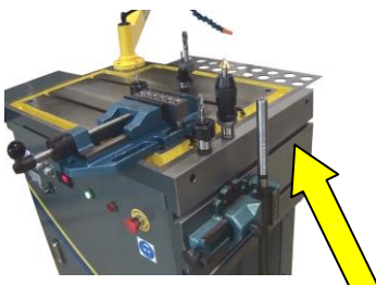
seitlicher Aufspanntisch zur stirnseitigen Bearbeitung langer Teile
